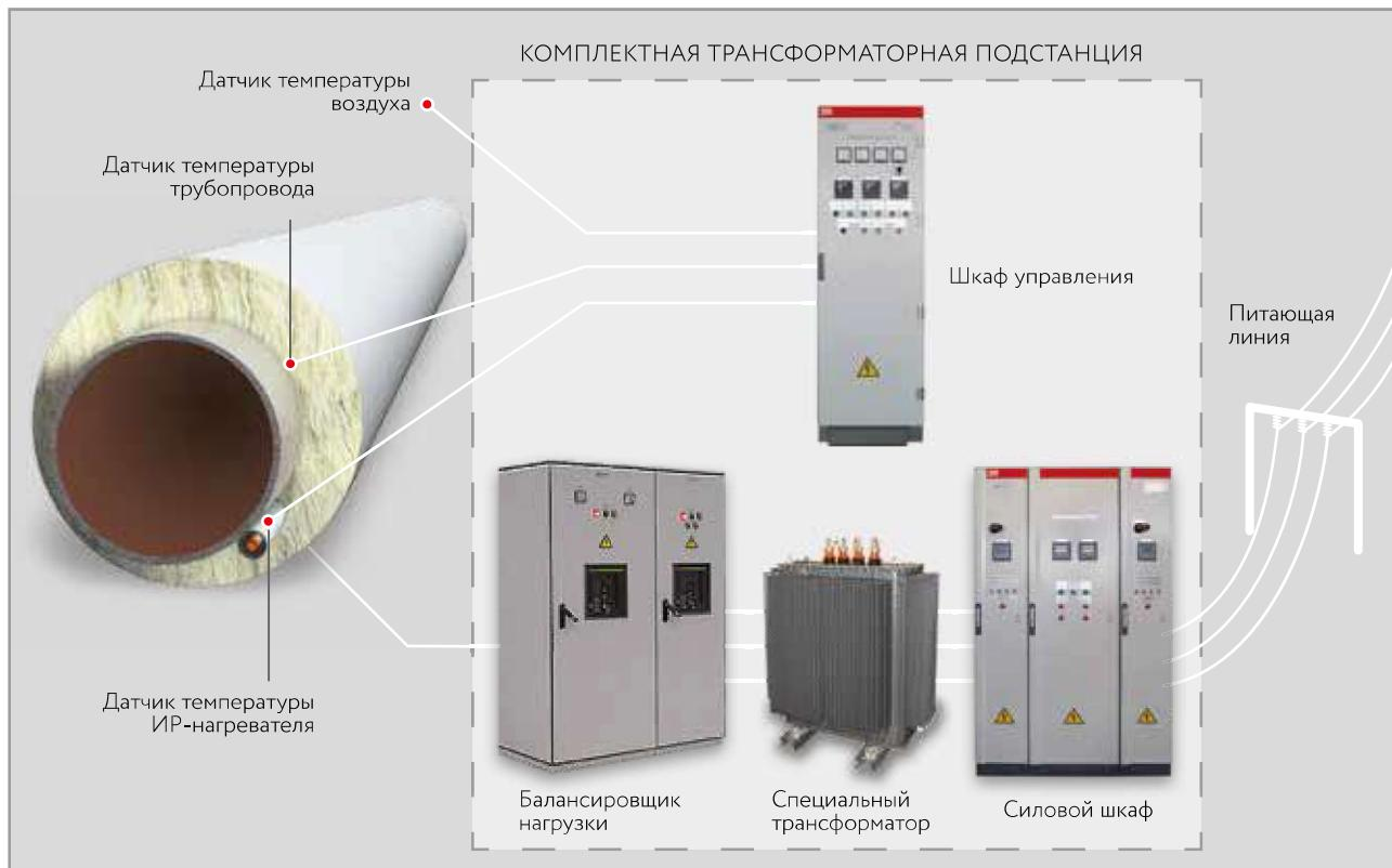
Для электроснабжения нагрузки применяются трансформаторно-конденсаторные преобразователи, которые состоят из балансировщика нагрузки и специального трансформатора. Это устройство позволяет подключать к трехфазной питающей сети мощную однофазную нагрузку (нагреватель скрин-системы), при этом перекос токов в питающей сети отсутствует.
