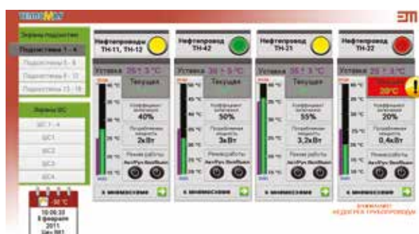
Примеры визуализации работы системы диспетчеризации
