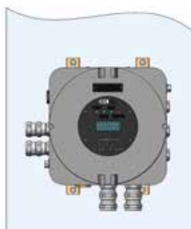
Установка на металлоконструкции
