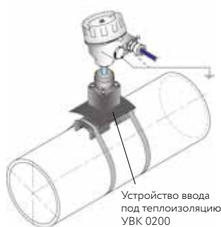
Измерение температуры трубы \varnothing \geq 57 мм
