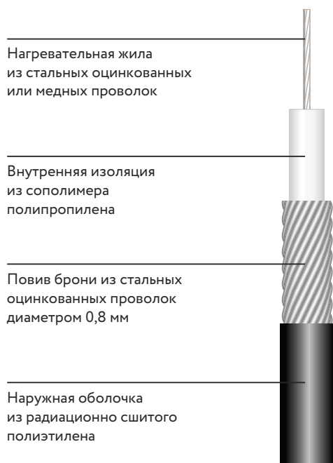
Рис.3. Конструкция кабеля НБМК.
